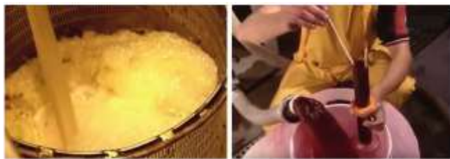
Рис. 245. Визначення якості сусла після пресування мезги: густина за аерометром (для розрахування вмісту цукру) та температура
