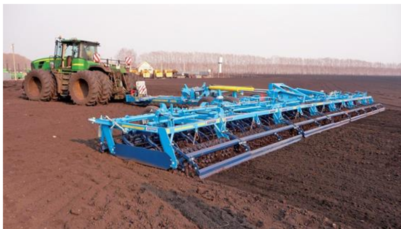
Рис. 5. Агрегат передпосівного обробітку ґрунту – КОМПАКТМАТ 1570МАХ
