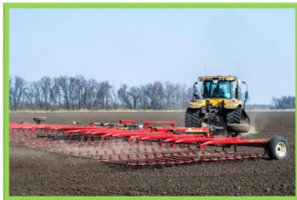
Рис. 14. Закриття вологи бороною McFarLane WDL-2000
