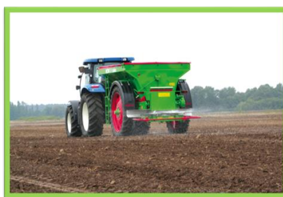
Рис. 5. Внесення мінеральних добрив розкидачем UNIA MX 950H
