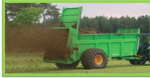
Рис. 6. Транспортування й розкидання твердих органічних добрив машиною Tornado 2
