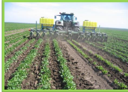
Рис. 7. Рихлення з підживленням цукрового буряку
