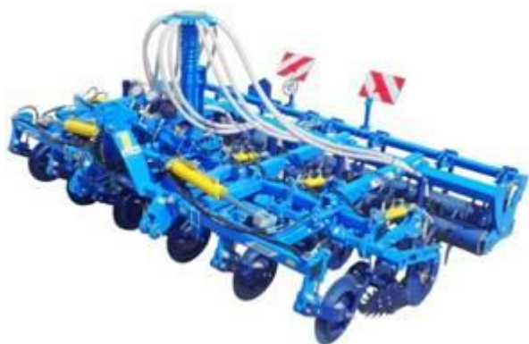
Рис.3. Смуговий культиватор Strip-Till
