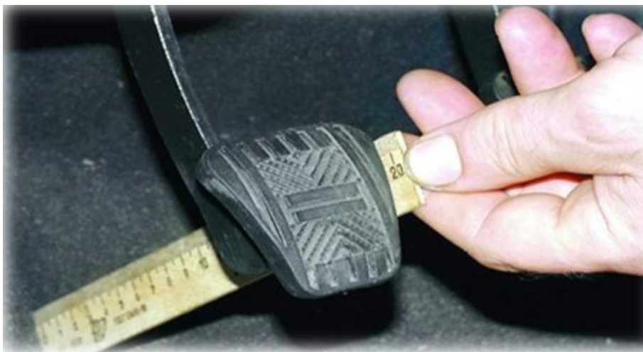
Рис. 5.3.5. Вимірювання вільного ходу педалі зчеплення
