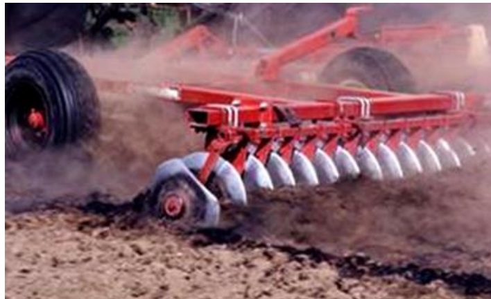
Рис. 8. Дискава борона в роботі
