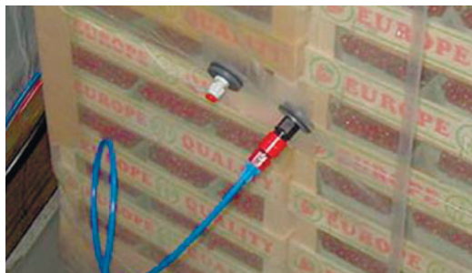
Рис. 116. Зберігання овочів у модифікованому газовому середовищі з використанням плівки
