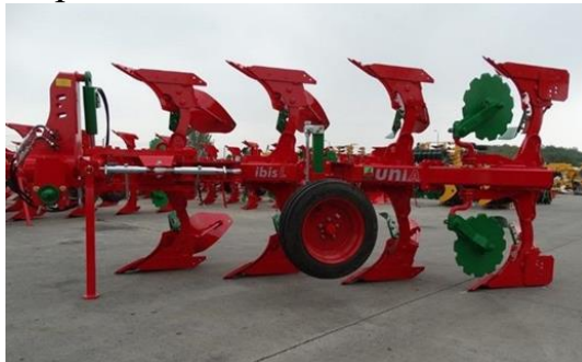
Рис. 14. Плуг IBIS LS 3+1 польської фірми Unia для гладенької оранки
