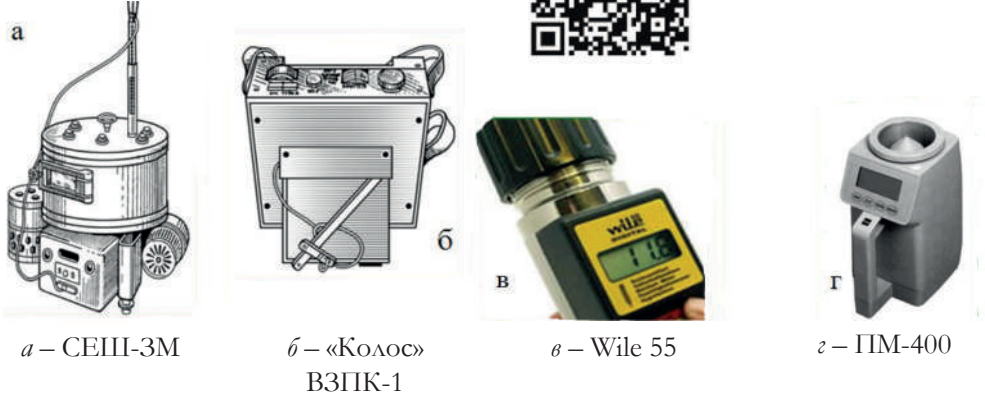
Рис. 27. Прилади для визначення вологості зерна
