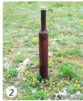
Опорний пункт державної геодезичної мережі (1). Репер – знак абсолютної висоти точки (2)
