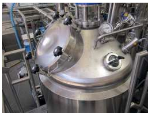
Рис. 236. Вакуум-апарат для уварювання повидла та джему
