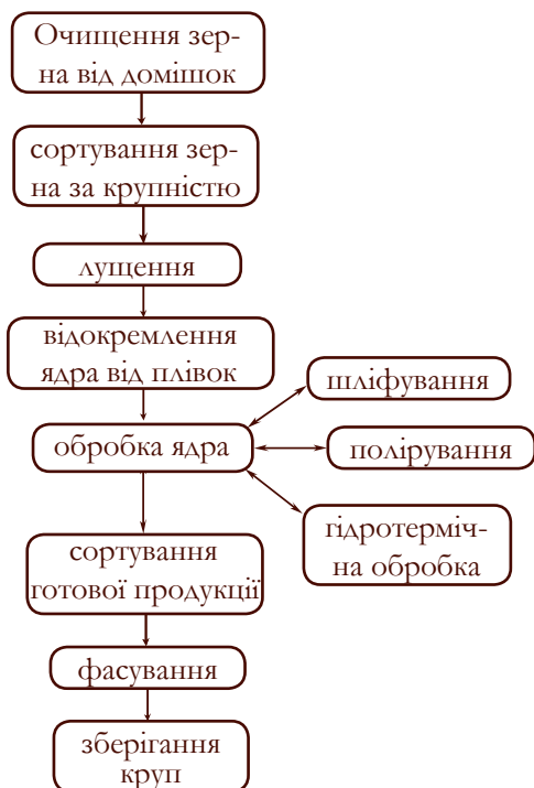
Рис. 72. Технологічна схема виробництва круп
