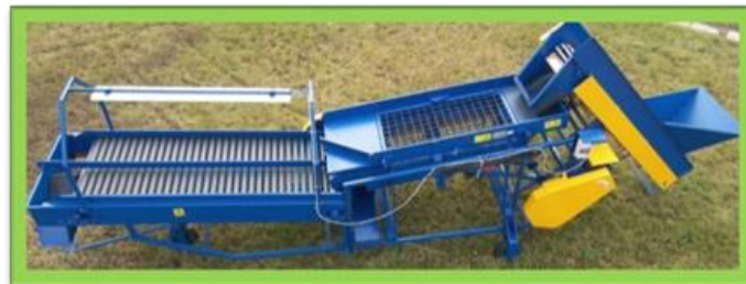
Рис. 62. Сортувальний стіл для картоплі – польська Rolmet M 614-1 – ПП
