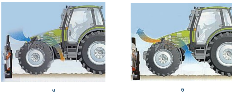
Рис. 3.8.69. Напряг повітряних потоків вентилятора Cleanfix:
