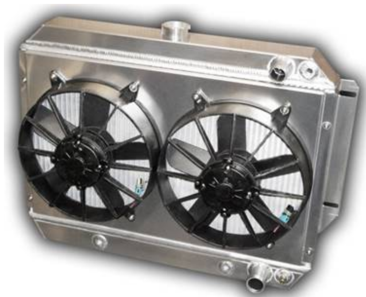
Рис. 3.8.32. Установка на радіаторі двох вентиляторів з електроприводом
