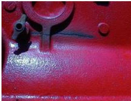
Рис. 3.8.49. Тріщина на блоці двигуна – результат «розморожування»
