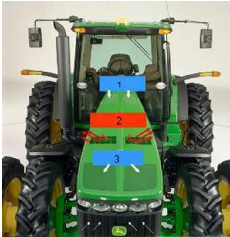
Рис. 3.8.61. Напрямок повітряних потоків у капоті трактора John Deere 8030:
