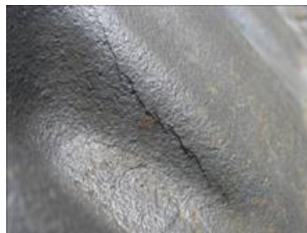
Рис. 3.8.49. Тріщина на блоці двигуна – результат «розморожування»
