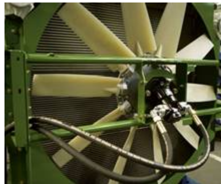
Рис. 3.8.65. Елементи гідростатичного урухомлення вентилятора:
