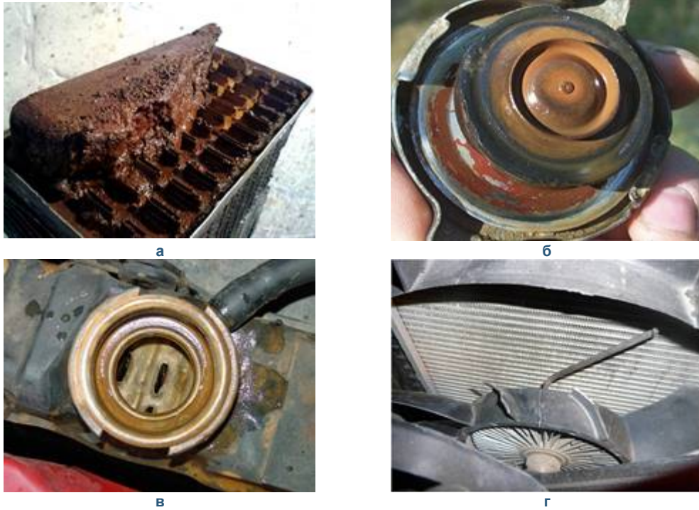
Рис. 3.8.87. Причини перегрівання двигуна:
