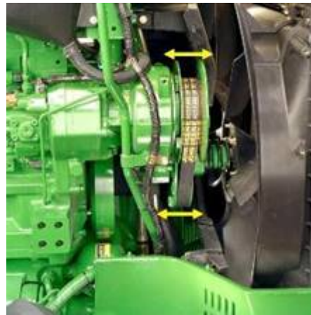
Рис. 3.8.60. Система охолодження Vari-Cool:
