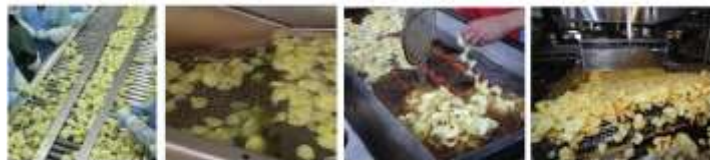
а – доочищення бульб б – різання в – обжарювання з – інспектування готової продукції
