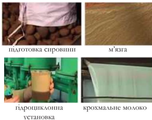
Рис. 297. Технологічні операції отримання крохмального молока
