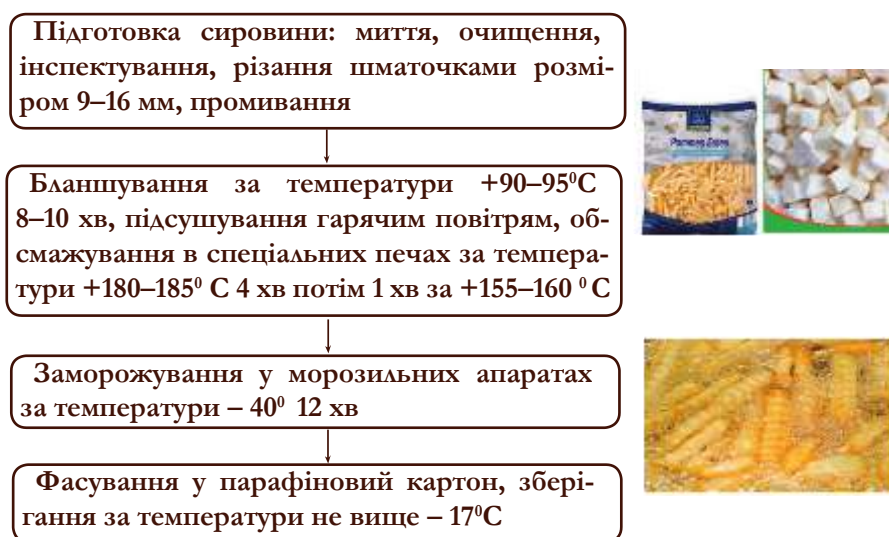
Рис. 295. Технологічна схема виробництва смаженої замороженої картоплі
