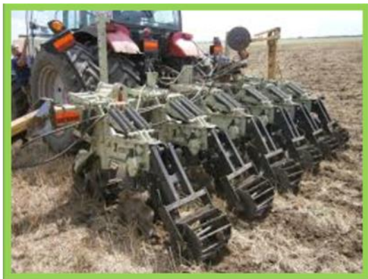
Рис. 12. Strip-till – ґрунтозахисна технологія. Нарізування смуг після озимої пшениці
