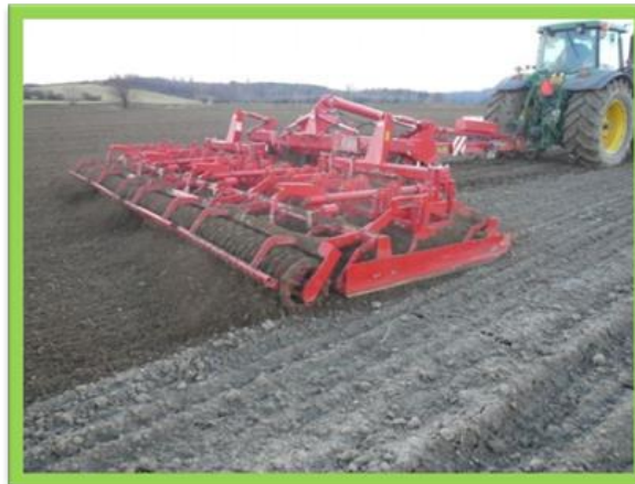
Рис. 5. Передпосівний обробіток ґрунту комбінованим агрегатом
